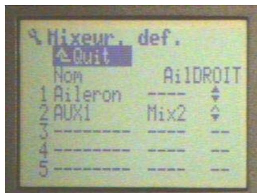
Mixeur " AiIDROIT " réalisé. Les lignes 3 à 5 sont laissées vierge.
