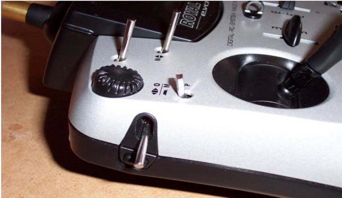
Un commutateur à déclencheur plat a été installé dans l'emplacement prévu. Trop épais, et inconfortable aux manipulations, il a dû être remplacé par un commutateur classique à déclencheur cylindrique.
