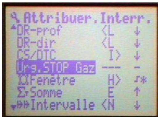
Le chronomètre de FENETRE est attribué au commutateur " **H** ". Le commutateur " **H** " a été programmé pour fonctionner en tant qu'actif en position haute, en mode M/A et non en mode momentanée.
