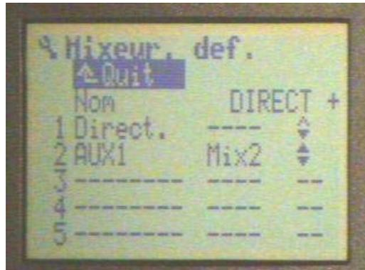
Mixeur " DIRECT + " réalisé. Les lignes 3 à 5 sont laissées vierge.
