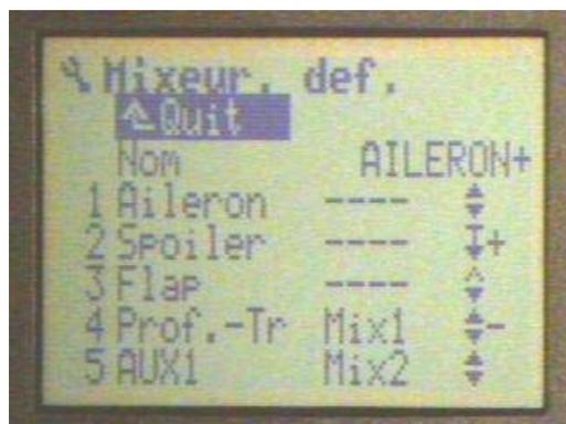
La cinquième ligne montre que la commande **AUX1** est maintenant devenue une entrée dans le mixeur " **AILERON+** ". Elle montre également que l'entrée de la commande **AUX1** a le commutateur logiciel **Mix2** qui lui est attribuée.
